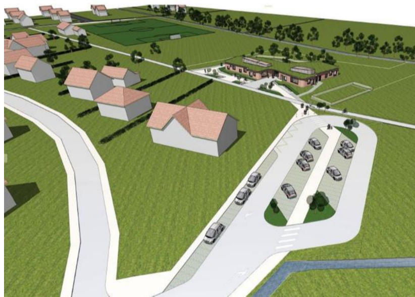
Une attention particulière a été portée à la sécurité : en éloignant le parking de l'entrée de l'école, les cheminements piétons et cyclistes ont été sécurisés. DOCUMENT REMIS – AJEANCE
